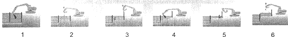
Rys. 5. Kolejność demontażu zabezpieczeń typu "PODLASIE 1"
